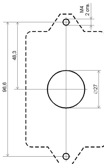
Рис. 3. Отверстия для монтажа модулей МДС-4 и МГ-4.
