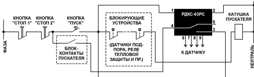
Рис. 3. Включение РС в схему блокировки автономного конвейера.
