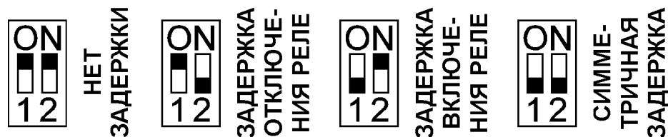
Рис. 6. Внутренние переключатели сигнализатора.
