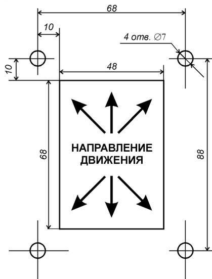
Рис. 4. Установочные отверстия для монтажа модуля ППМ-02Д.
