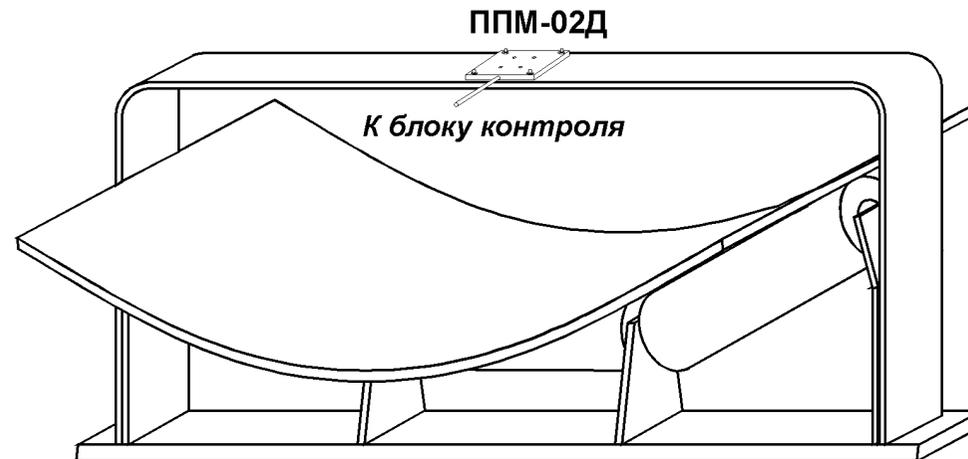
Рис. 9. Контроль наличия продукта на движущейся ленте конвейера.
