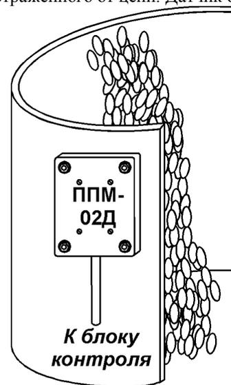
Рис. 5. Контроль движения потока продукта.
