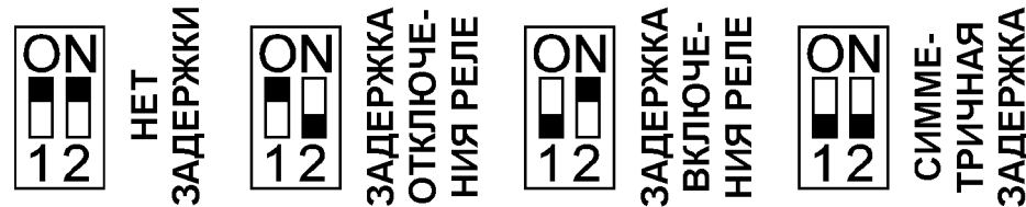
Рис. 4. Внутренние переключатели датчика РДД-02А.
