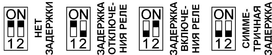
Рис. 4. Внутренние переключатели датчика РДД-02.
