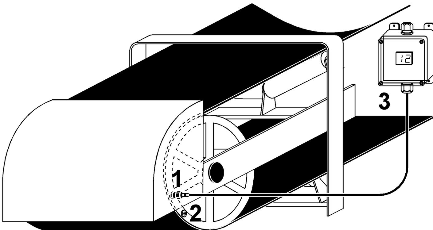
Устройства предназначены для механизмов, движущиеся части которых проходят в зоне действия датчика с интервалом от 0,05 до 100 секунд. Настройка на номинальную скорость производится **в автоматическом режиме**.
